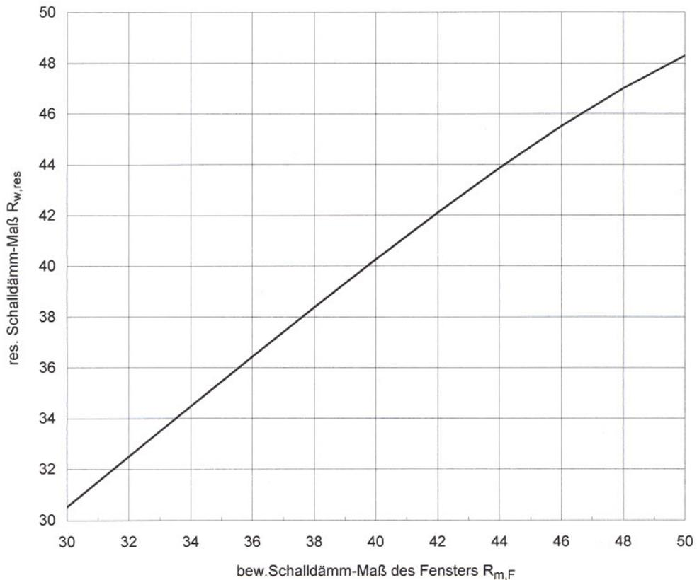
Anmerkung zur Umrechnung zwischen bew. Element-Normschallpegeldifferenz  $D_{n,e,w}$  und bew. Schalldämm-Maß  $R_w$
